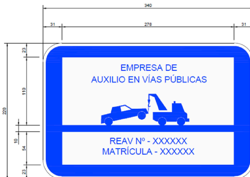
Placa de vehículo de servicio de auxilio en vías públicas
